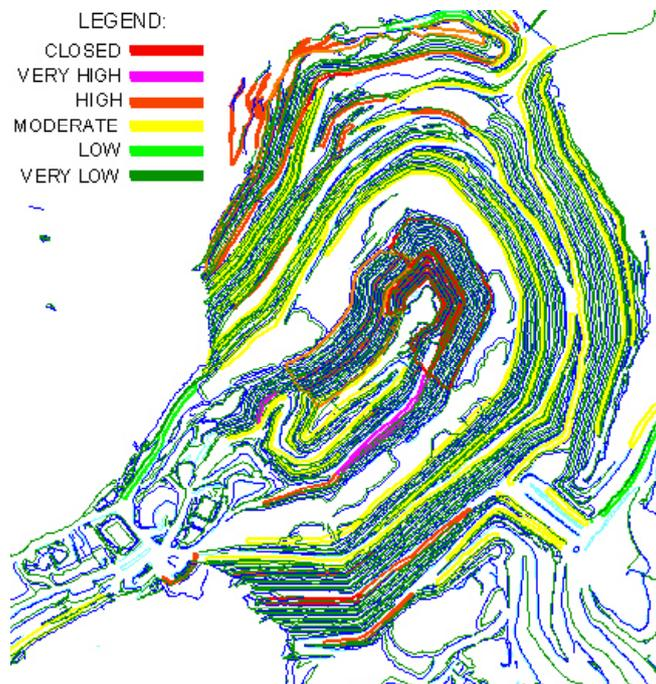
**Figure 7** - Typical Rockfall Hazard Plan (courtesy Compañía Minera Antamina S.A.)
