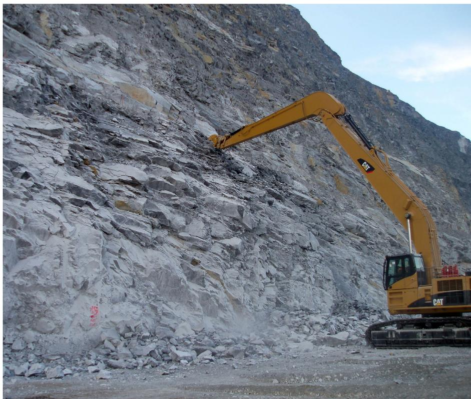
**Photo 1** - Long-boom Scaling Backhoe (courtesy, Compañía Minera Antamina S.A.)
